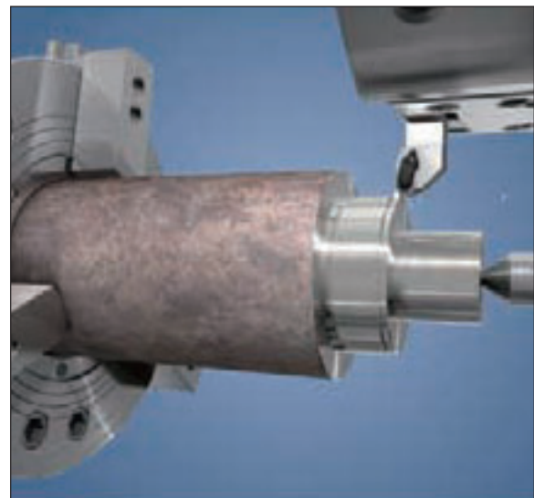
長尺ワーク加工時は芯押し台をご使用下さい
